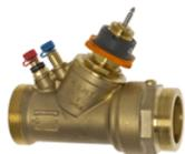
**Autres fonctions / caractéristiques** : Pression différentielle maxi  $\geq 600$  kPa (400 kPa pour les DN  $\geq 40$ ). Rangeabilité  $\geq 75$ . Prises de pression auto étanches. PN16. Plage de température fluide - 20°C/+120°C.
